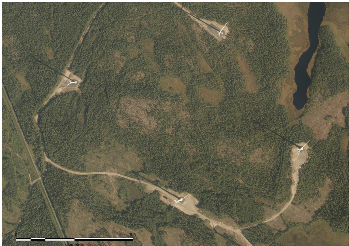
Kuva 2.11. Ilmakuvassa näkyy toiminnassa olevia tuulivoimaloita. Tuulivoimaloita varten on rakennettu huoltotiet ja kokoamis- ja nosturialueet. Tuulivoimaloiden ympäristössä ja välissä aikaisempi maankäyttö on säilynyt ennallaan.
