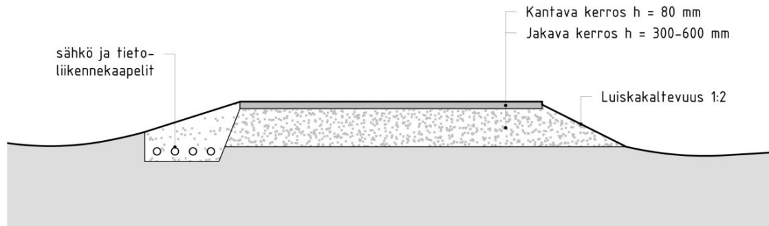
Periaatekuva uuden ja perusparannettavan tien rakenteesta.
